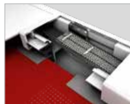
Vue de coupe - rail de guidage avec système zip et profilé en plastique à l'intérieur et courroie en tissu élastique.
