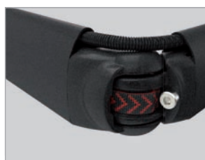
Bionic-Sehne und verdeckte Stromführung in den Armen
